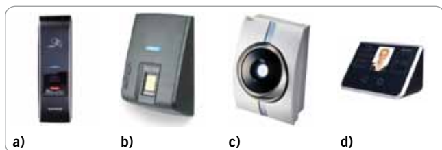
Obr. 17 Systémy pro biometrickou identifikaci: a) Optický snímač otisku prstů, b) kapacitní snímač otisků prstů, c) snímač oční duhovky, d) terminál s rozeznáváním modelu obličeje (Suprema BioEntry, Aktion AXR-500, LG IrisAccess 3000, Aktion AFT-500)
