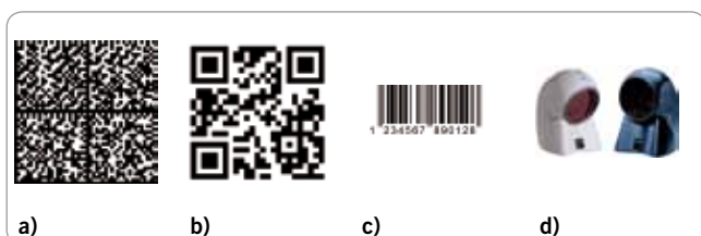
Obr. 16 Optická identifikační média: a) příklad optického kódu data matrix, b) QR kód, c) EAN-13, d) čtečka MK-7120 Orbit (Honeywell.)
